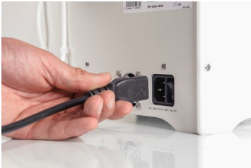
8. 将电源线连接到打印机, 另一端连接到电源插座。
