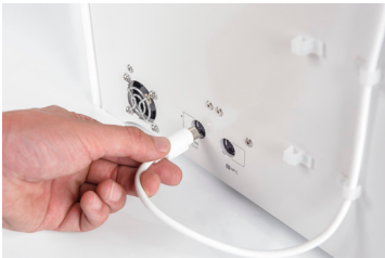
5. 断开 Air Manager 电缆端与线夹的连接, 并将其连接至 UMB OUT 端口。
