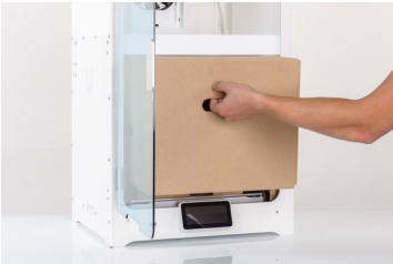
1. 打开 Ultimaker S7 的包装并从打印机内部取入门套件和包装材料。
