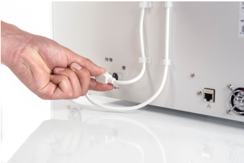
7. 将线轴架电缆连接到 NFC 插口, 并固定在线夹后面。
