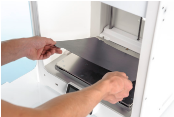
2. 将柔性构建板与打印平台后部的卡位销对齐, 然后将其放低直至卡入相应位置。
